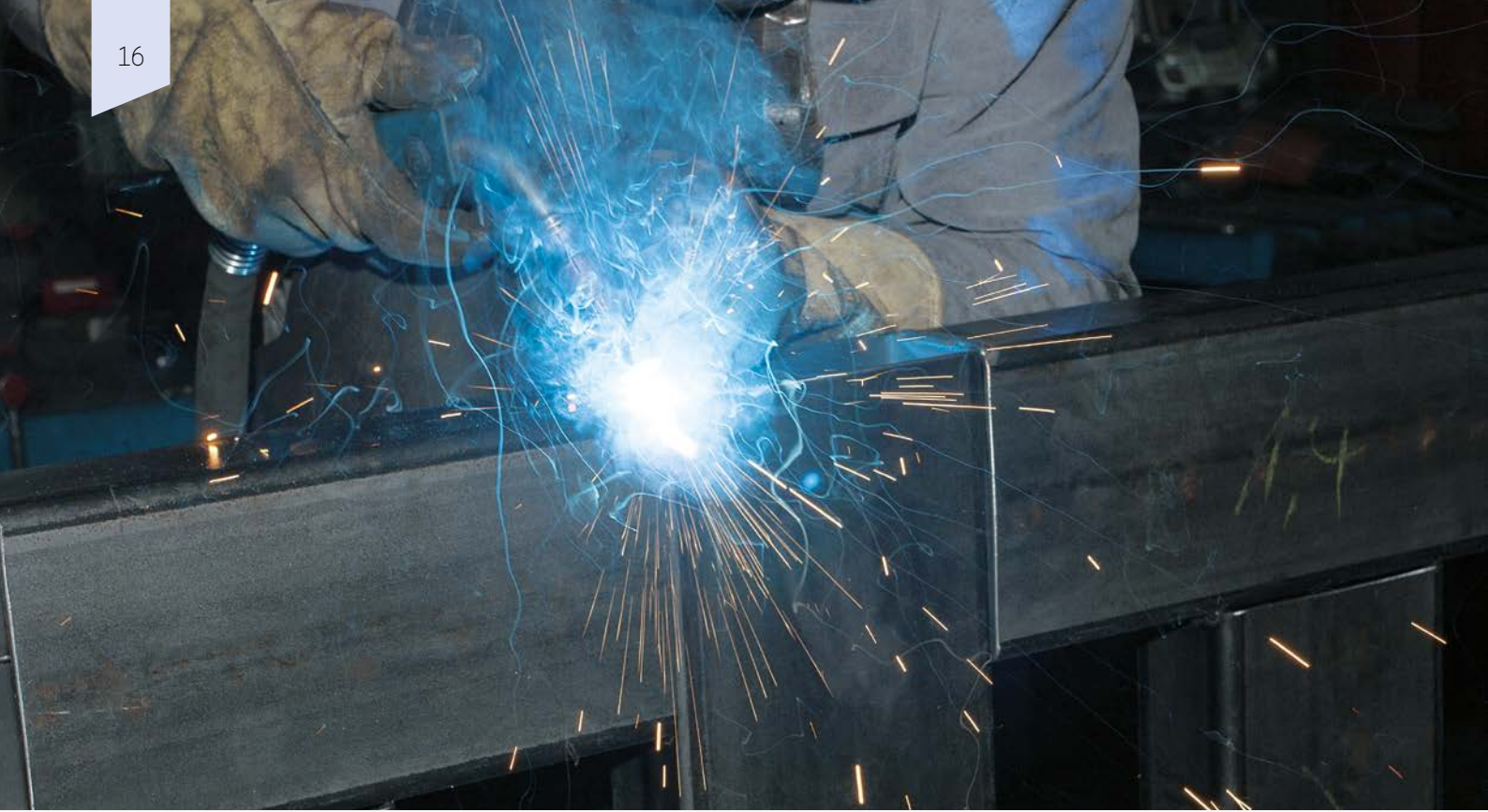
Verschweißen eines Grundgestells
