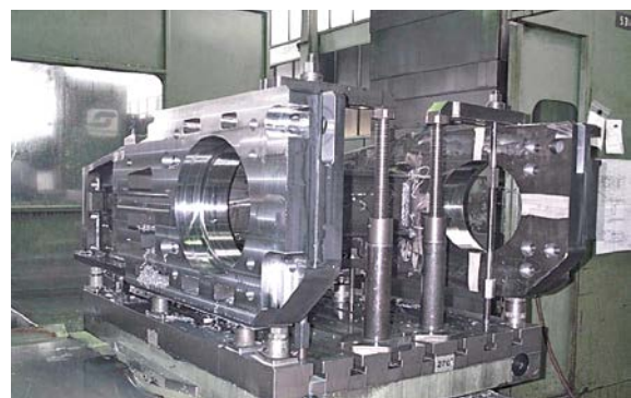
Schweiß- und Bohrwerksbearbeitung
